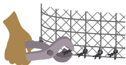
Amarração da base com a parede da cisterna
